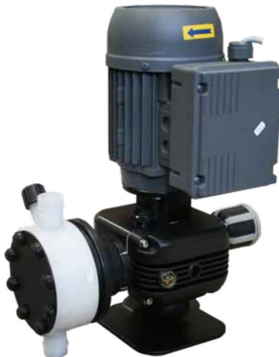
La gamme PRIUS utilise la technologie des pompes électromécaniques à membrane attelée, équipée d'un rappel à ressort. Par ses mouvements, la membrane aspire puis injecte le produit à doser et ce, dans un cycle de volume constant. Le débit est ajusté par le réglage de la course de la membrane : cette course est réglable de 0 à 100% via une mollette.
