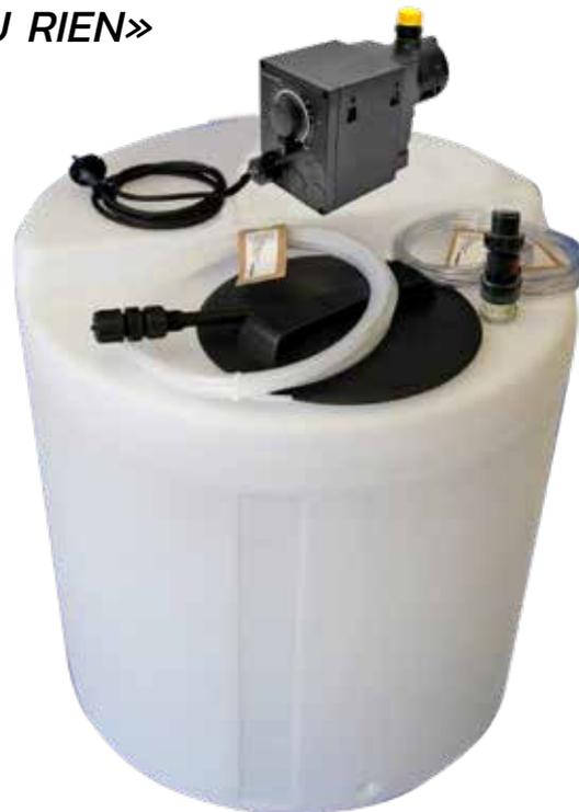
Le kit de dosage «tout ou rien» est utilisé principalement pour réaliser de la chloration sur les eaux de puits ou de forage pour maîtriser la qualité bactériologique. Le fonctionnement de la pompe doseuse est alors asservi au fonctionnement de la pompe de transfert. La quantité de produit injecté est ajustable par réglage du débit de la pompe doseuse de 0 à 100% de son débit maximum.
