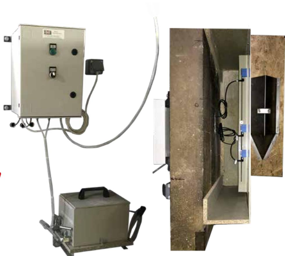
Le DTLG est un dispositif automatique de désinfection des trayons en couloir pour les caprins et ovins en sortie de traite. Ce dispositif externe à la machine à traire et indépendant utilise le **principe d'atomisation**.
