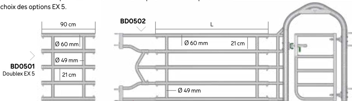
Exemple monté avec un avant de découpe EX 5 et un avant EX 5 passage large
