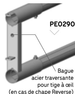
**Embout engraissement 2 tubes**
