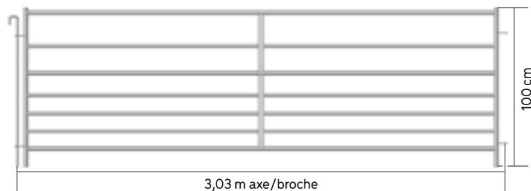
**OV3720** Claie ovin 7 lisses H. 1 m L. 2 m avec broche - Existe en pack x 12 18 kg
