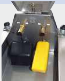
Avec un flotteur supplémentaire Basse Pression (jaune)
