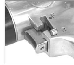
**Perceuse 10 mm est équipée de série, d'un inverseur de sens de rotation.**
