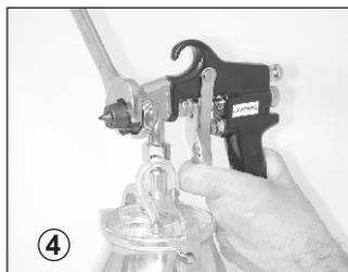
Desserrer la buse à l'aide d'une clé plate ou à pipe de 22.
