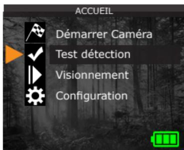
Lorsque la caméra détecte un mouvement, la lumière de test clignote. Si le système ne détecte pas les mouvements, augmentez la sensibilité de détection à l'aide de l'option « sensibilité » située dans le menu de CONFIGURATION/GÉNÉRAL. Ajustez la position de votre caméra au besoin. En mode TEST, il est
